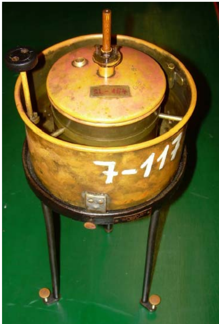
Historický viskozimetr podle Englera s ověřovacím listem:
