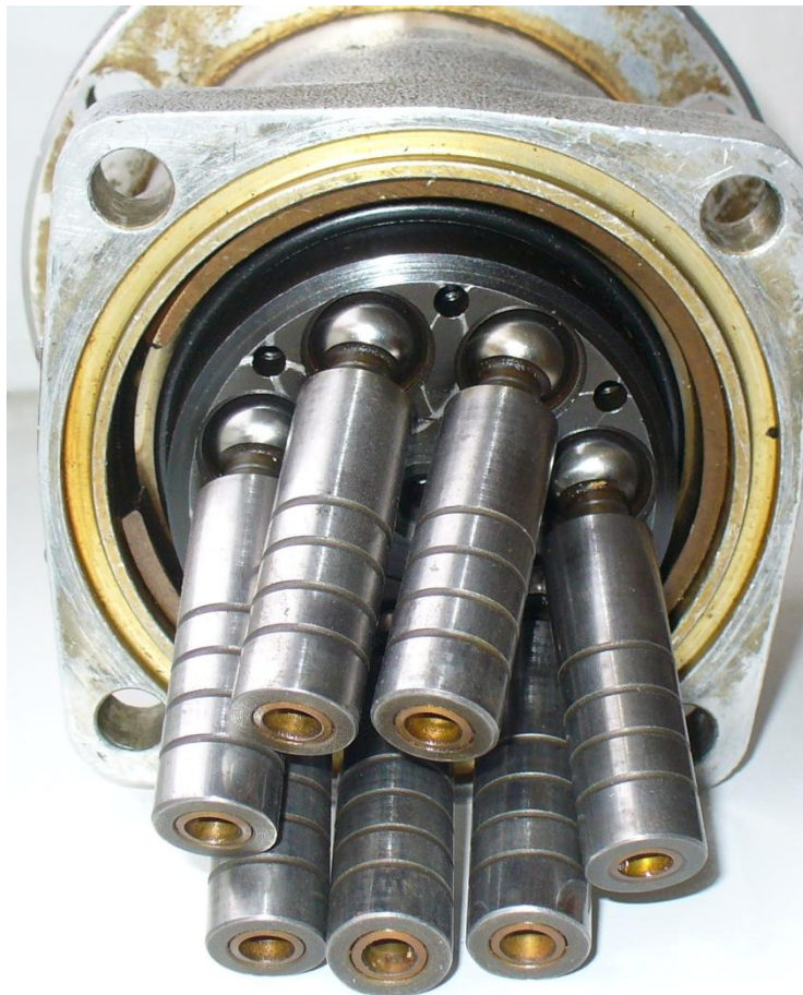
Axiální rotační pístový hydromotor.
