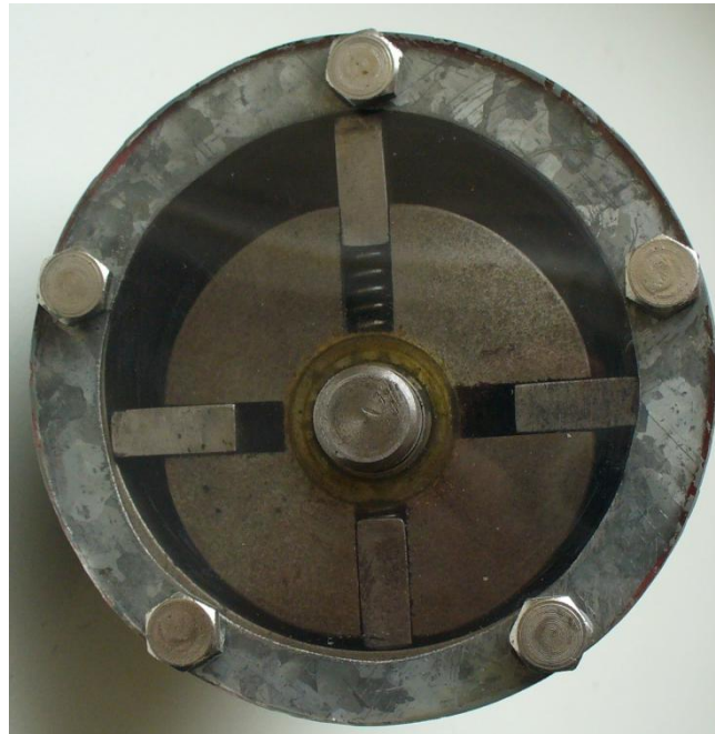
Nevyvážené lamelové čerpadlo (může pracovat i jako hydromotor).
