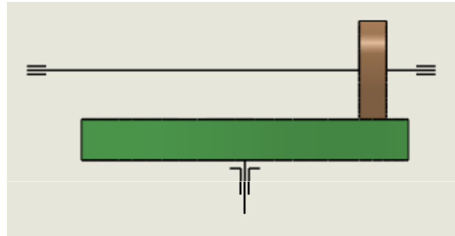
Schéma třecího převodu s lícními koly.
