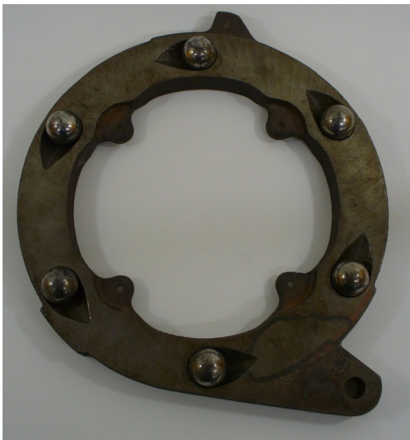
Vnitřní strana přitlačného kotouče brzd systému GIRLING
