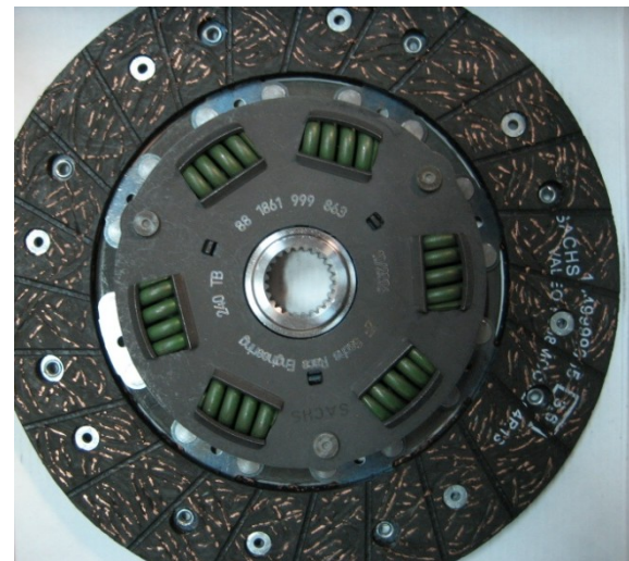
Třecí kotoučová spojka a obložení spojkového kotouče [7]
