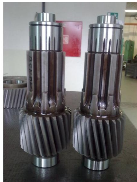
Příklad rovnobokého drážkování, převzato z [5]
