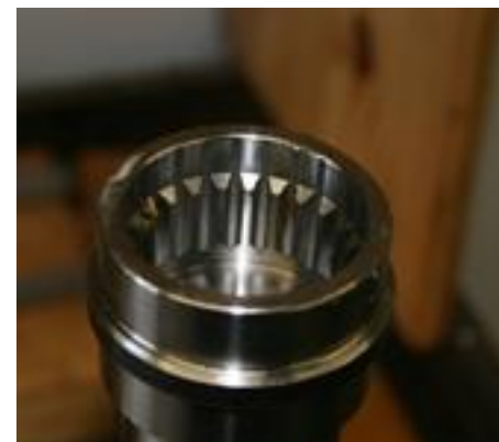
Příklad evolventního drážkování, převzato z [6]
