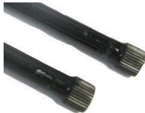
Příklad jemného drážkování, převzato z [7]
