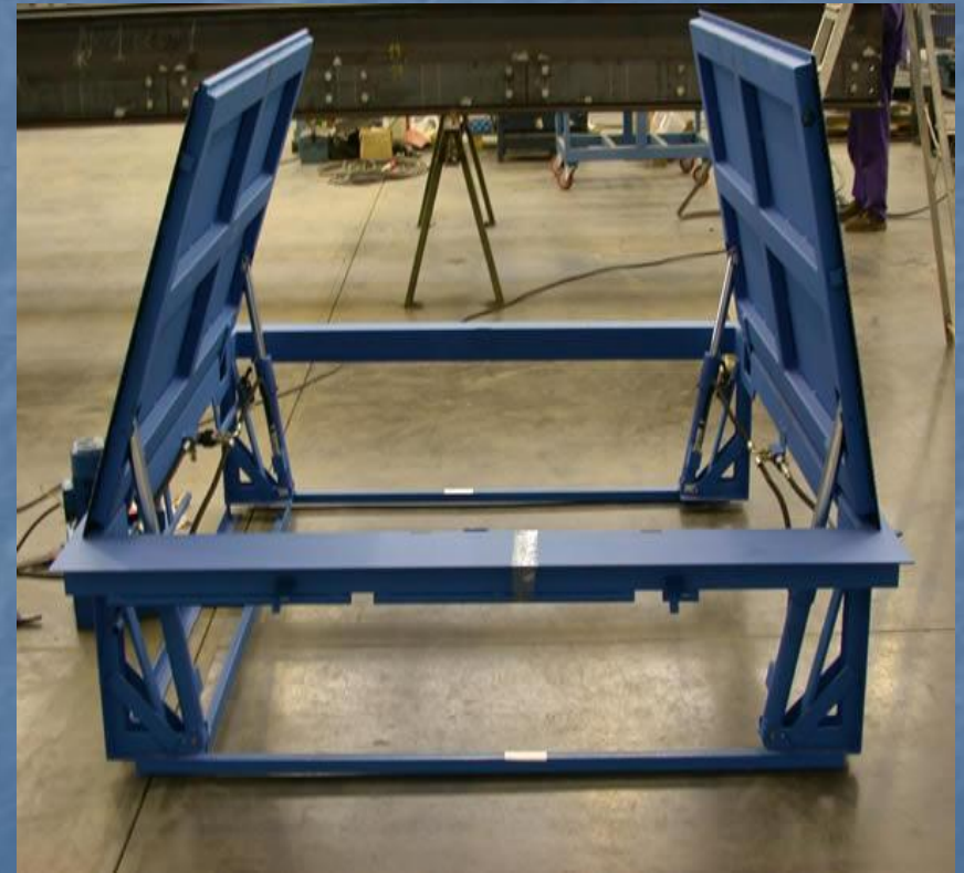
Poklop stolového výtahu
