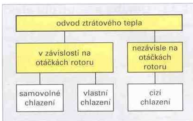
Obr. 1 Způsoby chlazení motorů
