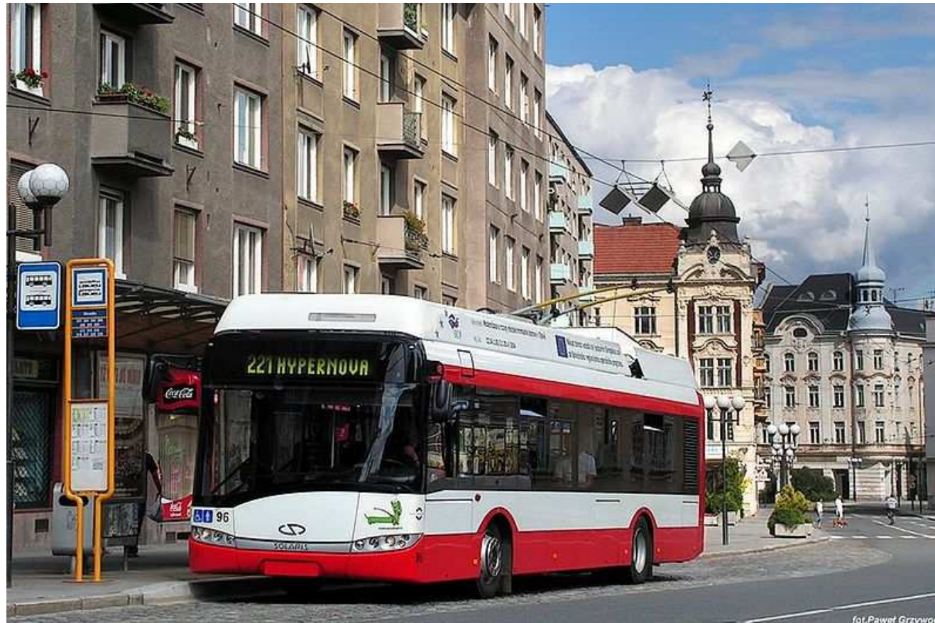
Obr. 2. Opavský Solaris Trollino 12 AC s pomocným dieselagregátem
