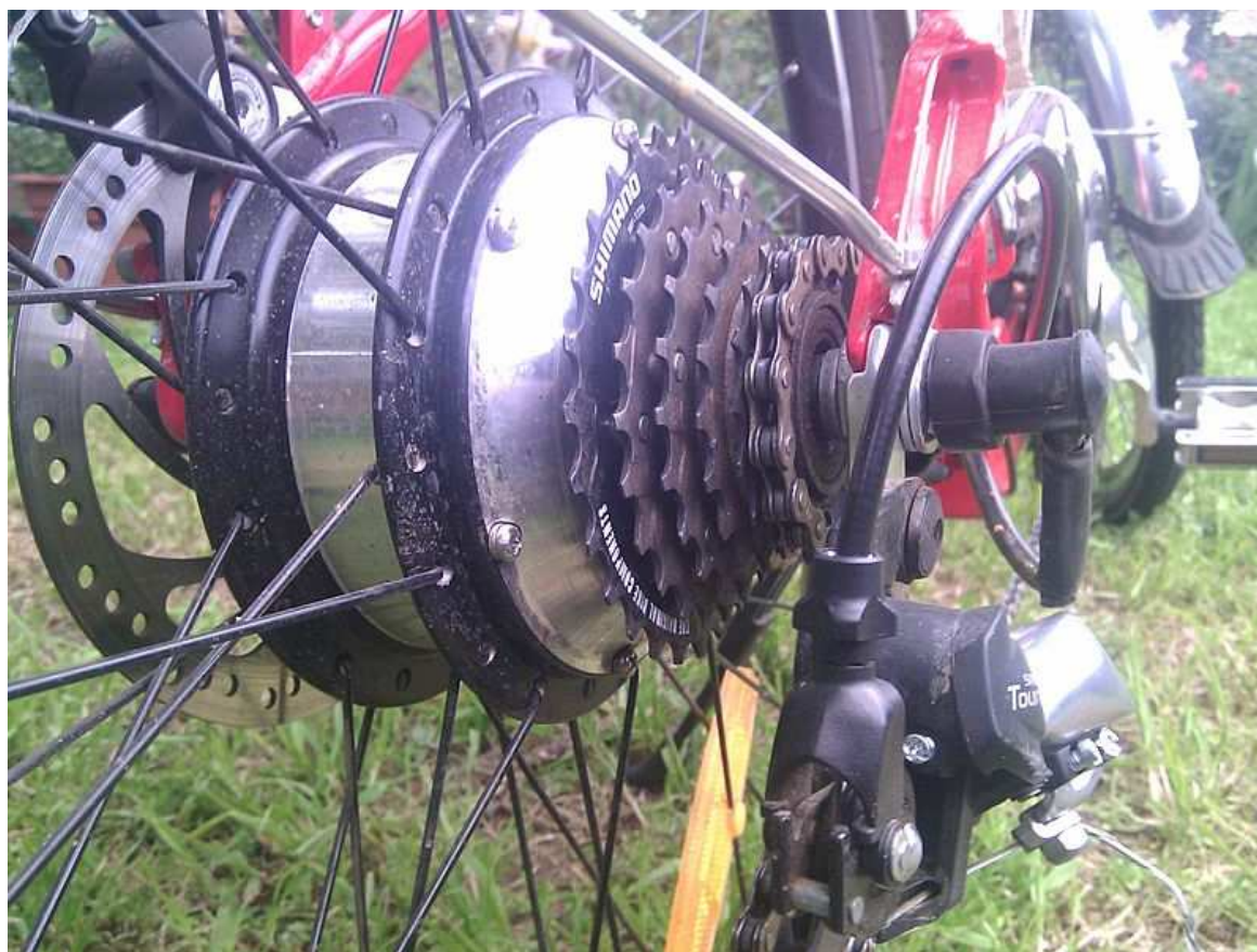
Obr. 1. - Pohled na motor zabudovaný v náboji zadního kola.
