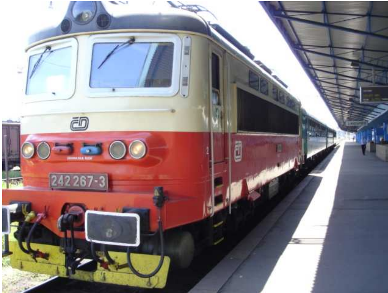
Obr. 1. – střídavá elektrická lokomotiva - 25kV/50Hz – výrobce Škoda Plzeň
