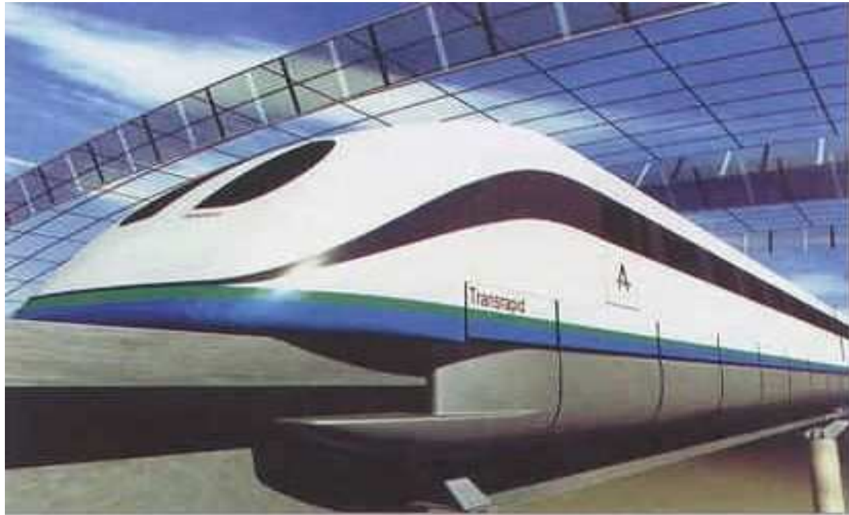
Obr. 1 Magnetická dráha poháněná lineárním motorem
