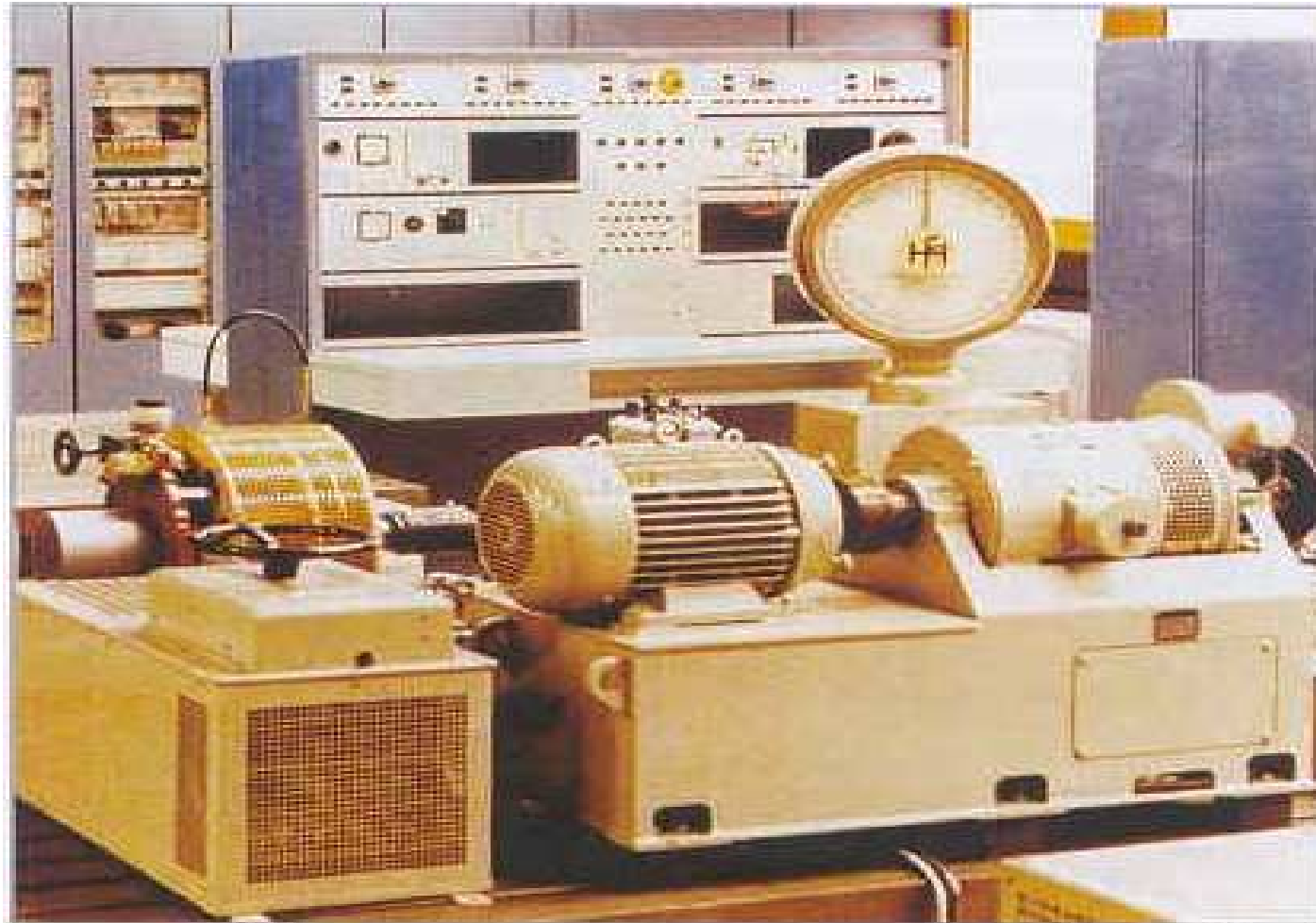
Obr. 3 Zkušebna motorů s dynamometrem
