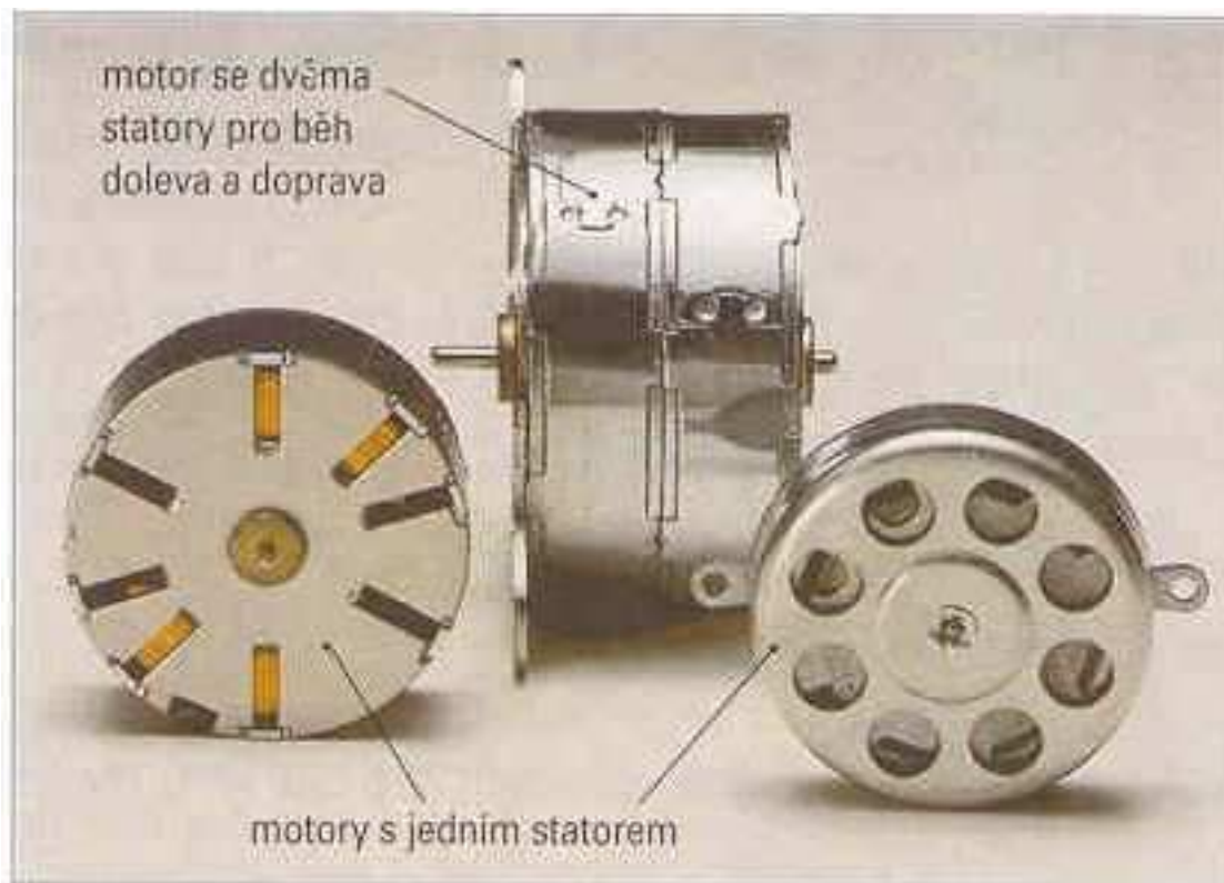
Obr. 5. - Malé synchronní motorky s kotvou z permanentního magnetu (2W až 5W, 375.5 otáček/min).
